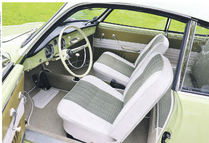
Die Stoff für die Bezüge der Sitze und Türverkleidungen kam aus den USA. Weil der Farbton nicht entsprach, wurden der Stoff von Martin Pöhli nachgefärbt.
