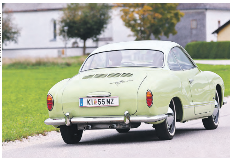
Im Heck des Karmann-Ghia schnurrt ein luftgekühlter Vierzylinder-Boxermotor vom VW-Käfer mit 1192 ccm und 34 Pferdestärken.
