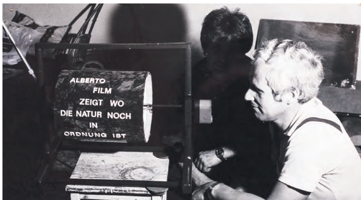
Im analogen Zeitalter war Einfallsreichtum gefragt: Mit Hilfe einer umgebauten, angetriebenen Waschmittel-Trommel, wurden die Texte abgefilmt und im Film eingearbeitet.
