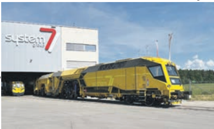
Von Laakirchen in die Welt: Der Universal Tamping Robot 4.0 mit vollhydraulischem Stopfantrieb
