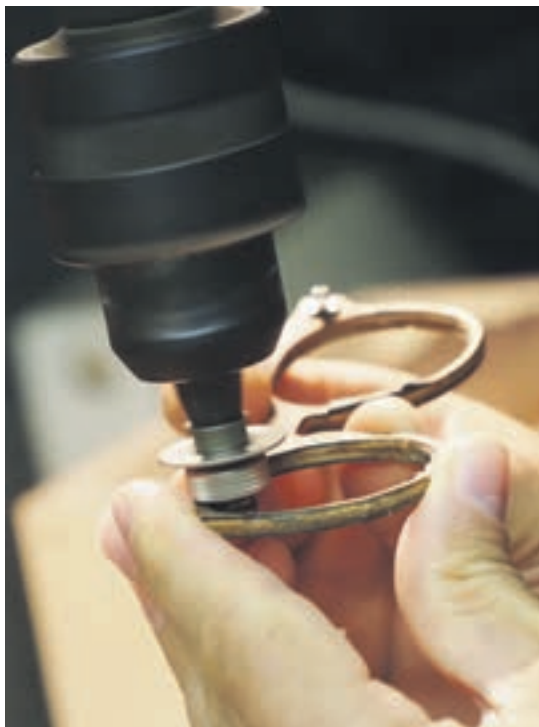
Eine Nut im Brillenrahmen hält das Glas fest, das am Rand keilförmig angeschliffen ist.
