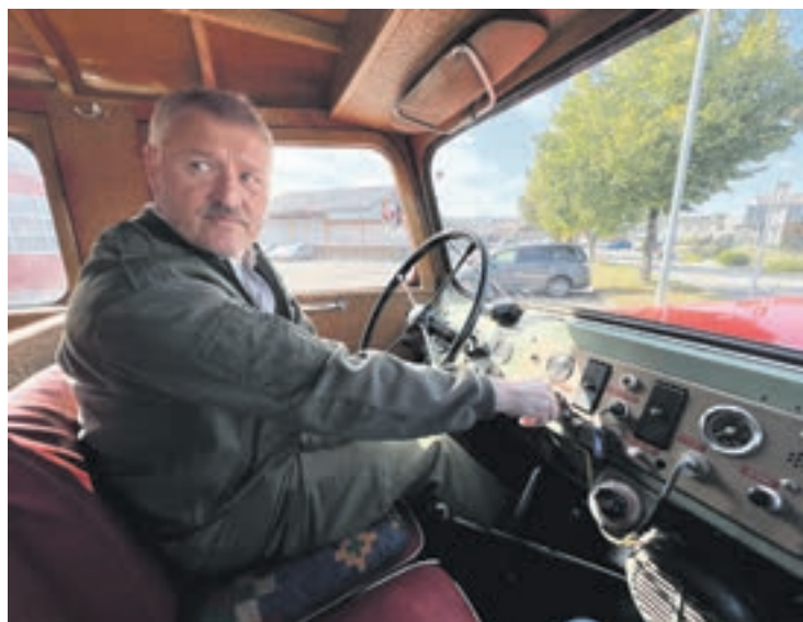
Hansjörg Steininger – von 2018 bis 2023 Kommandant der FF Sierning – im Führerhaus aus Holz, das mit Blech verkleidet ist. Das nicht synchronisierte Fünfganggetriebe erfordert gefühlvolles Fahren mit Zwischengas.
