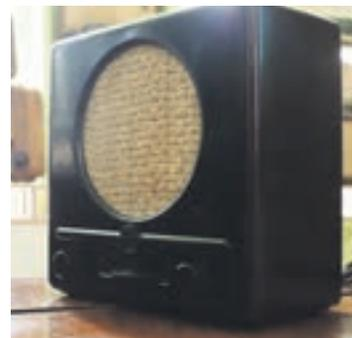
Da steht er, der geheimnisumwehte Volksempfänger aus der Nazizeit – hier als „Deutscher Kleinempfänger“. Jeder Betrieb, der Radios baute, musste den herstellen und zu einem Fixpreis verkaufen. Kleinere Hersteller hat das in den Ruin getrieben. Technisch war das Ding eher einfach gebaut.
