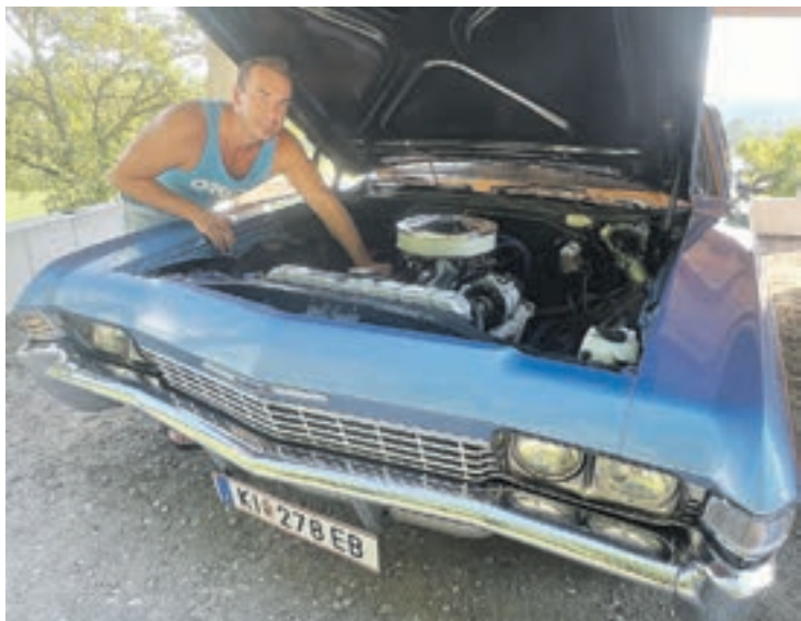
Der 5,4 Liter Motor mit 250 Pferdestärken sorgt für das unverwechselbare „V8 Blubbern“.
