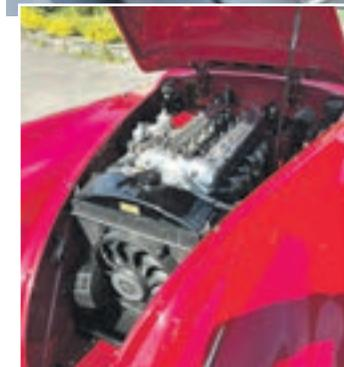
**Der edle Innenraum ist mit Ledersitzen ausgestattet, das Armaturenbrett wurde aus Nusswurzelholz gefertigt (oben). Unter der Motorhaube schnurrt ein bärenstarker Sechszylinder Reihenmotor mit 3,5 Litern Hubraum. Mit über 200 km/h war der Jaguar XK 120 der schnellste Sportwagen seiner Zeit.**
