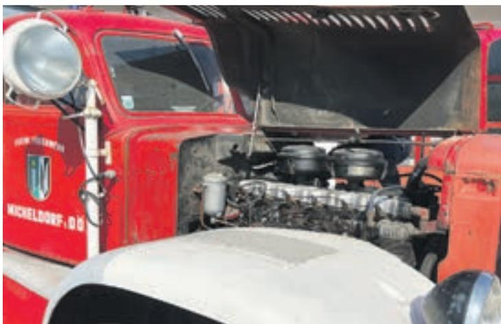
Ein Dieselmotor „Steyr WD 613“ ersetzte 1952 den ursprünglichen Benzinmotor.
