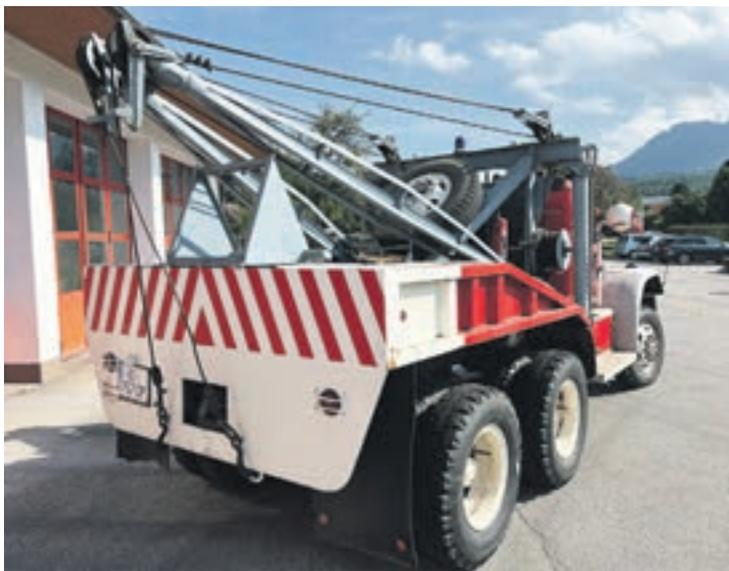
Die hintere Kraneinrichtung verfügt über zwei Seilwinden mit einer Hubkraft von jeweils 50 Tonnen (50 kN).
