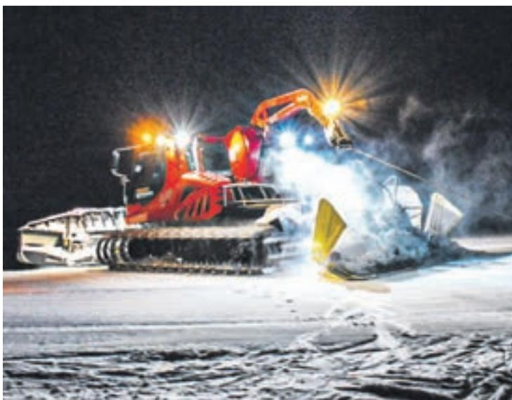
Die Pistenbullys sind auf der Höss nach der Pistensperre hauptsächlich im Dunkeln im Einsatz. Die Fräse am Heck zerkleinert den Schnee, die gelbe Gummimatte dahinter sorgt für die typischen Rillen auf frisch präparierten Pisten.
