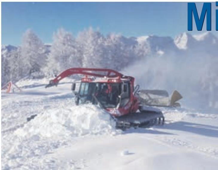
Mit dem großen Schild, das über zwölf verschiedene Bedien-Funktionen verfügt, wird der Schnee verteilt.
