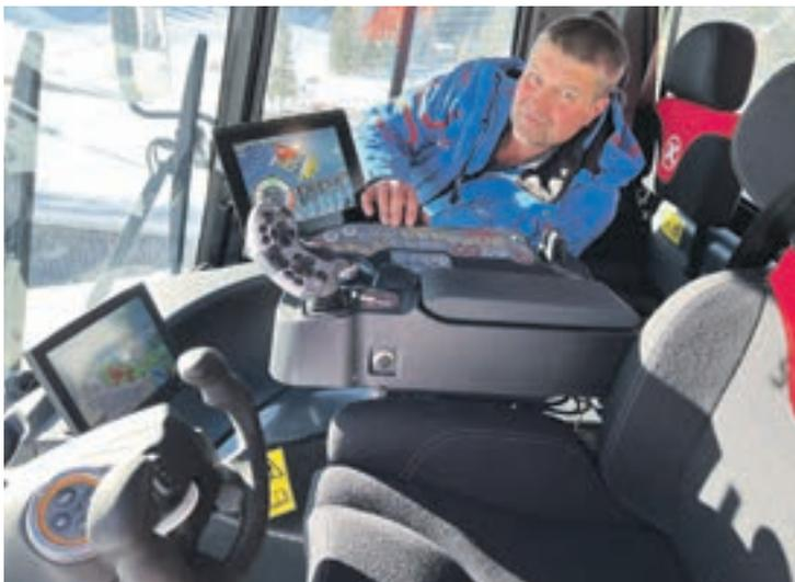
Mit dem U-förmigen Lenkrad und einem Joystick mit unzähligen Funktionen wird der Pistenbully gesteuert.
