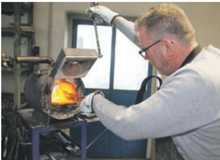
Im Gasbrennofen werden die Stahlpakete auf etwa 1.250 Grad erhitzt.
