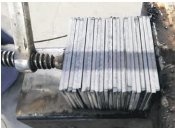
Für die Klinge werden abwechselnd wenige Millimeter dicke Plättchen aus Mangan- und Nickestahl übereinander gelegt und zu Stahlpaketen feuerverschweißt.
