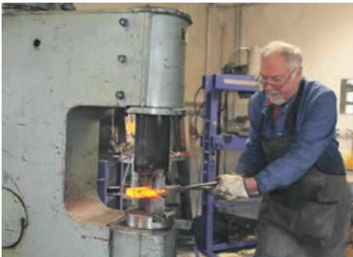
Unter großem Druck werden die glühenden Pakete am Lufthammer ausgeschmiedet.
